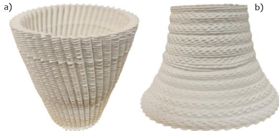
Figura 7. a) Impresión 3D de un bowl cerámico utilizando la formulación C20 con 20% de caolín, b) impresión 3D de un recipiente utilizando la formulación C30 con 30% de caolín.
