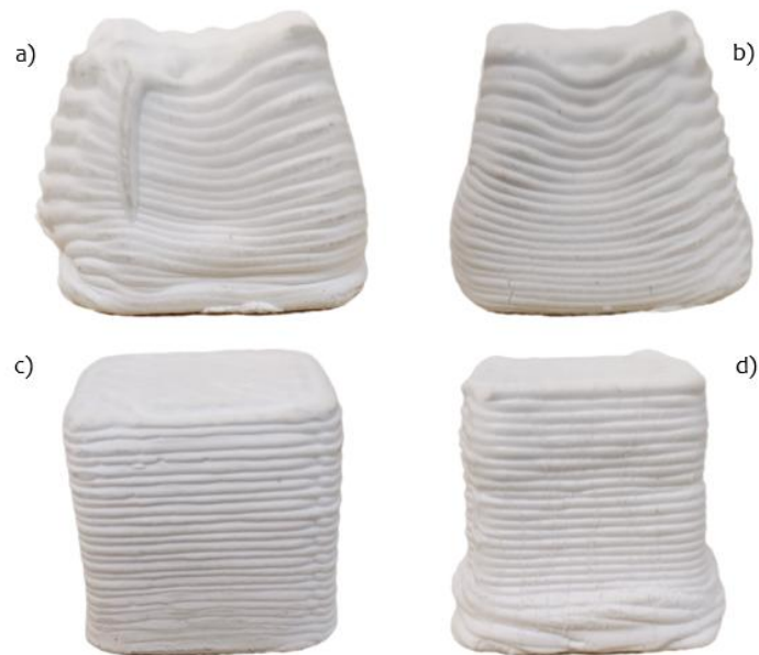
Figura 6. Variación de caolín en la pasta impresa: a) 0% caolín, b) 10% caolín, c) 20% caolín, y d) 30% caolín.
